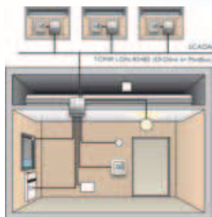
Regio Maxi: свободно программируемые контроллеры с поддержкой сетевых протоколов и веб-интерфейсом.
