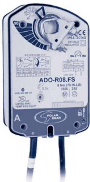
Электрические приводы Polar Bear разработаны специально для использования с воздушными заслонками в системах вентиляции и кондиционирования. В каждый привод встроена система «Safety» с возвратной пружиной, обеспечивающая при аварийном отключении напряжения полное закрытие воздушной заслонки для предотвращения размораживания водяных теплообменников.
